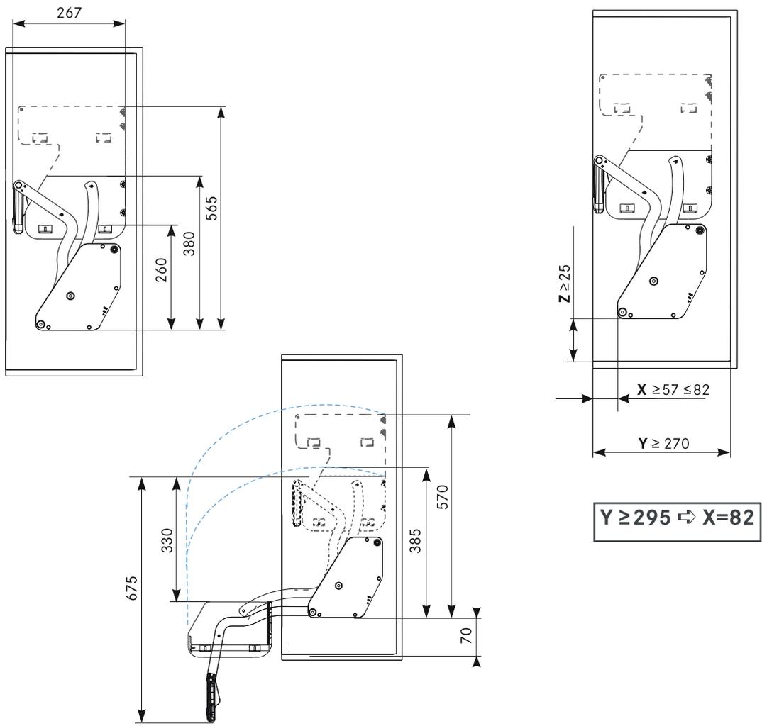
**Gabarit de perçage des ergots de positionnement**
