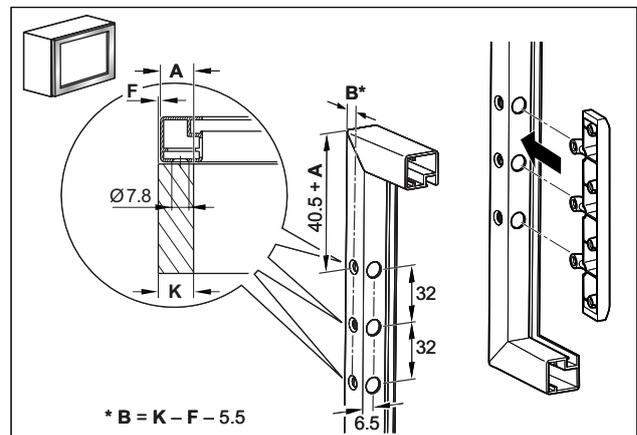
Assemblage de façade pour cadre en aluminium de 20 mm
