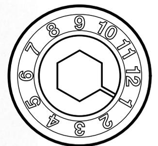
Réglage de la force par paliers au moyen de la clé.
